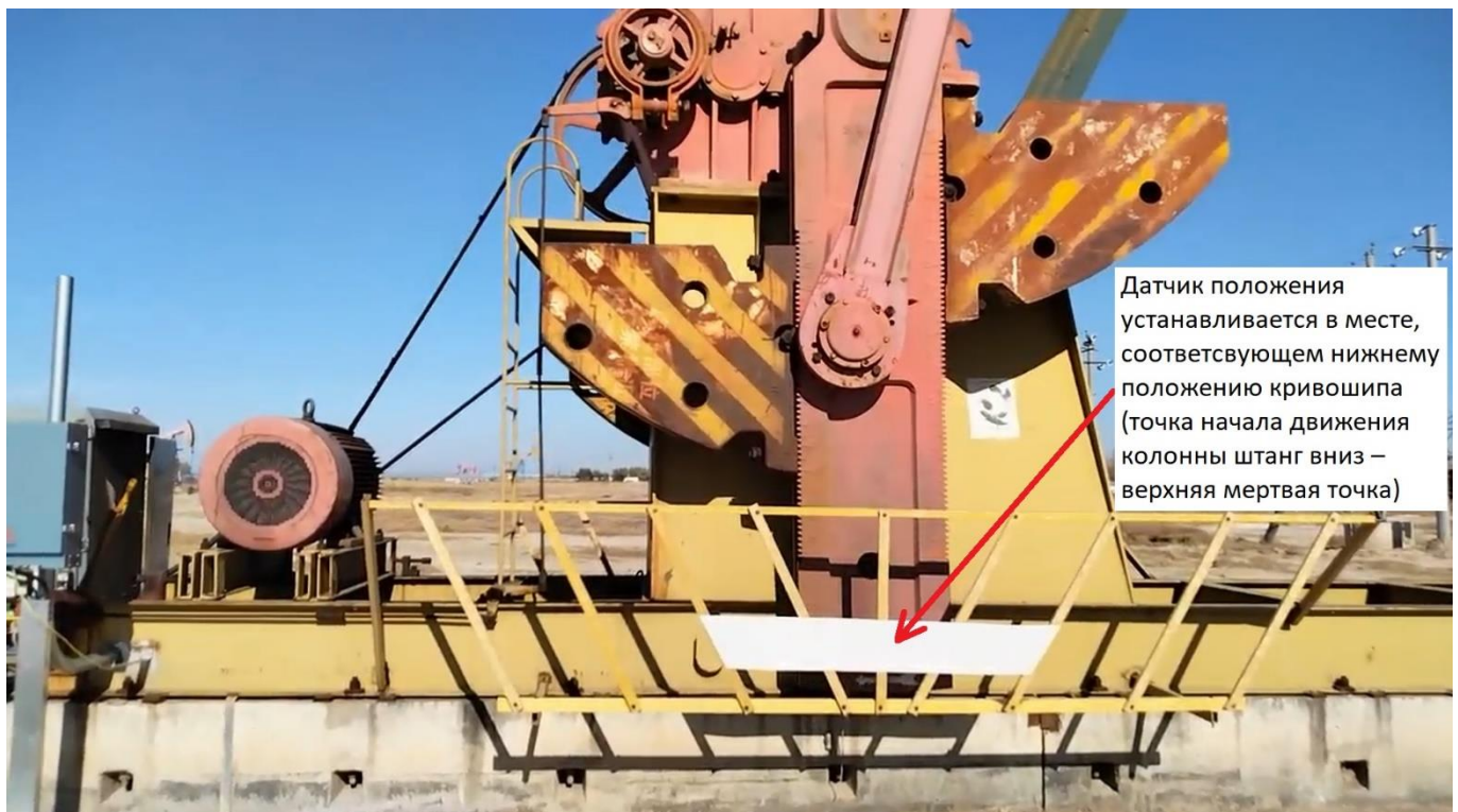
Рисунок 5.4-1 – Место установки датчика положения кривошипа
